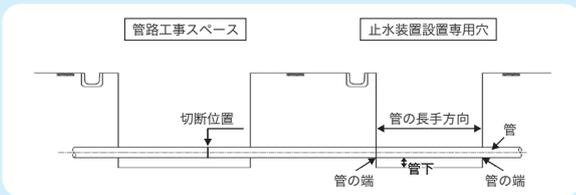
管路工事箇所と止水装置設置専用の穴を掘って単独で設置する場合、次のスペースを確保します。
