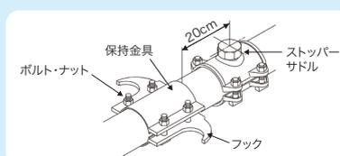
エアバッグが保持金具の取り付け部で膨らむため、保持金具は管を保護する働きがあります。保持金具は管の種類と呼び径を確認し、管に合ったものを使用してください。
